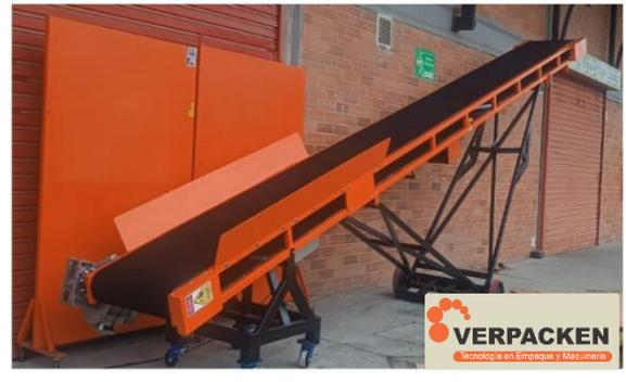
Estas bandas de carga y descarga esta diseñada para optimizar tiempos y movimiento al momento de la movilización de cargas de entrada o salida de camiones, evita lesiones al personal de carga y minimiza el numero de operarios que involucra este proceso.
