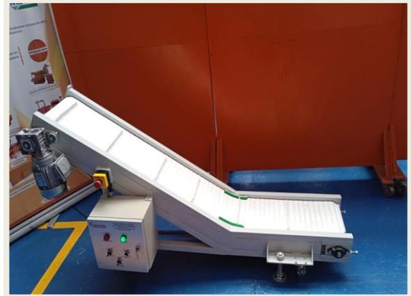
Fabricación de bandas transportadoras en Z en acero col rolled pintura electrostática dependiendo la necesidad.
