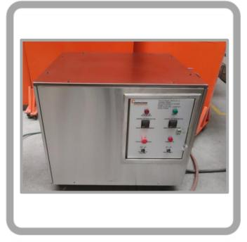
El calderín eléctrico industrial es un equipo térmico importante en la producción industrial, puede producir vapor en combinación con el túnel ayuda al proceso de Termoencogido de etiquetas.
